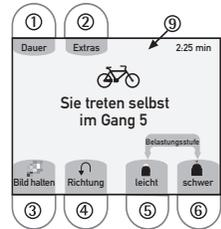
Abb. 10 ⑨ erscheint ein Fahrrad und der Hinweis „Sie treten selbst“. Mit den Tasten „leicht“ (kleines Gewicht) ⑤ und „schwer“ (großes Gewicht) ⑥ können Sie die Bremsbelastungsstufen, angepasst auf Ihre Muskelkraft, verändern, d.h. den Gang von 0 bis 20 einstellen. Wählen Sie die Bremsbelastungsstufe so, dass Sie ohne große Anstrengung trainieren können. Es ist besser, längere Zeit in einem kleinen Gang zu treten.
