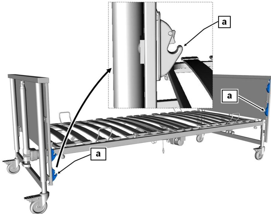
**Wichtig:** Die Führungsschienen **[11]** müssen vor Beginn der Montagearbeiten diagonal zueinander stehen (siehe Bild). Stellen Sie hierfür die kopfseitige Führungsschiene hoch, und senken Sie die fußseitige Führungsschiene ab.
