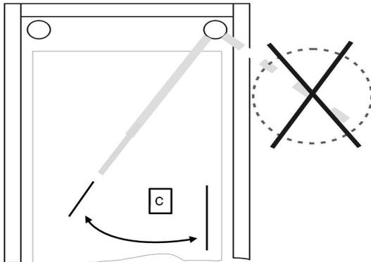
Teil C: Abb.4: Schwenkbereich des Aufrichters
