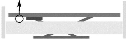
Die Oberkante des Liegeflächenrahmens [1] muss 60 mm über der Oberkante des bettumbaus abschließen!
