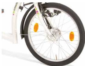
**Die Bremswirkung kann nach häufiger Nutzung nachlassen, geben Sie daher Acht, den Bowdenzug der Bremse regelmäßig nachjustieren, wenn Sie einen Verlust der Bremskraft bemerken (siehe Punkt 3.2.1)**
