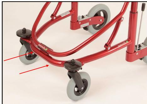
Die Rumpfstütze sollte bei Gebrauch des Easy-Walker DS immer nach oben geschlagen sein. Ziehen Sie diese zunächst nach hinten heraus. Schieben Sie sie dann nach oben. Anschließend können Sie sie aufrichten und herunter drücken, damit sie arretiert ist. Wiederholen Sie den Vorgang in umgekehrter Reihenfolge, um die Rumpfstütze wieder einzuklappen.
