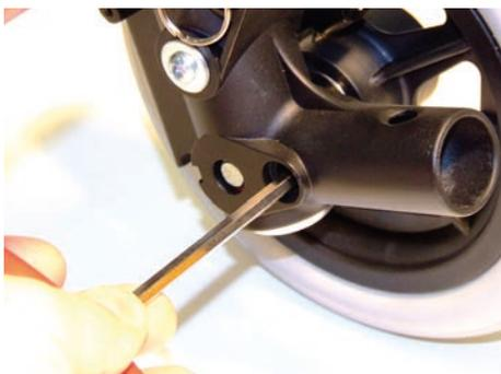
Durch Hinein- oder Herausdrehen des innenliegenden Gewindestiftes kann der Druck der Schleifbremsen auf die Radnabe und damit die Abrollgeschwindigkeit der Räder verändert werden.
