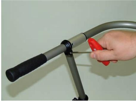
Bei FLUX Gr. 1 - 3 muss die Haltebügeltiefe so eingestellt sein, dass die Vorderkante der Griffe bzw. der Unterarmschalen auf dem Haltebügel mindestens um das Maß (A) hinter den Lenkgabeln liegt. Bei Verwendung von Abweisrollen erhöht sich das Maß (A) um einen Zentimeter.
