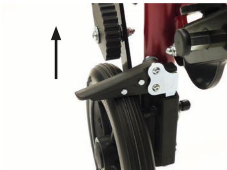
Zum Feststellen wird der obere Klemmbügel nach unten auf das Rad gedrückt bis die Bremse sicher einrastet.
