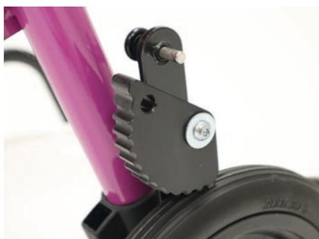
Nach Ziehen des Zugschnappers kann die Rücklaufsperr soweit nach vorne geschwenkt werden bis der Bolzen wieder einrastet. Damit ist die Rücklaufsperr abgeschaltet. Die Lauflernhilfe kann somit nach vorne und hinten frei bewegt werden.
